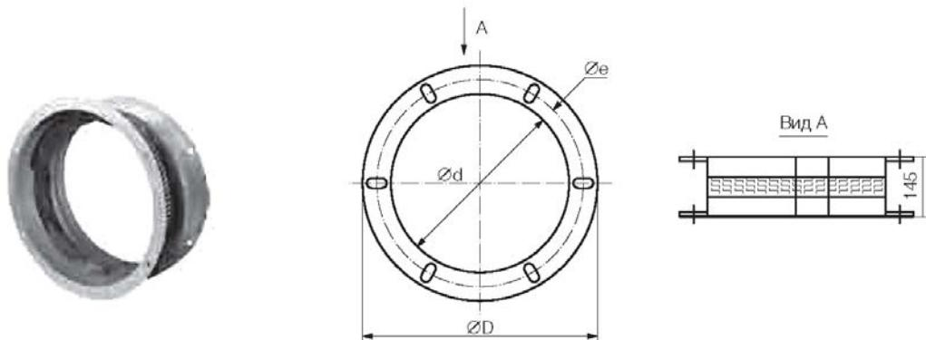
Гибкие вставки FCV из неопреновой ткани с фланцами из оцинкованной стали.
