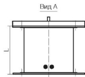
Обратные клапаны BDD из оцинкованной стали с алюминиевыми створками.
