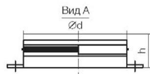
Фланцы FGV с резиновым уплотнителем для присоединения вентиляторов к воздуховодам. Изготавлены из оцинкованной стали.
