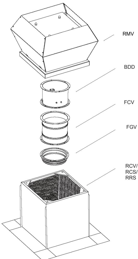
Крышный короб должен быть прочно прикреплен к крыше так, чтобы установленный вентилятор находился в горизонтальном положении.
