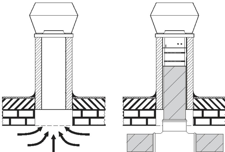
Оборудование можно подключить таким образом, чтобы оно вытягивало воздух непосредственно из вентилируемого помещения или по системе воздуховодов.
